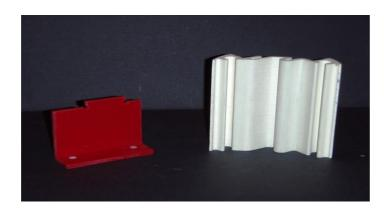
MP3 GPO3 è un composito stratificato compost da vetro opaco e resina poliestere con buone caratteristiche elettriche e meccaniche fino a 155°C, autoestinguente UL 94 – VO e MI-FO. Resiste molto bene all'arco e alla traccia elettrica in ambienti particolarmente ostici.
